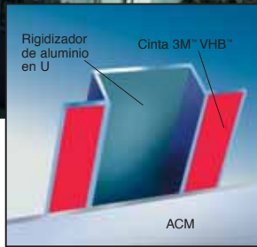
Plaza Centenario, Sao Paulo, Brasil Arquitecto: Carlos Bratke, 1995 Rigidizadores de aluminio pegados a paneles ACM
